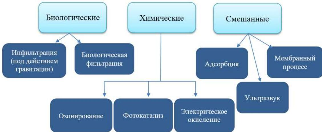
Рисунок — Технологии очистки загрязняющих веществ
