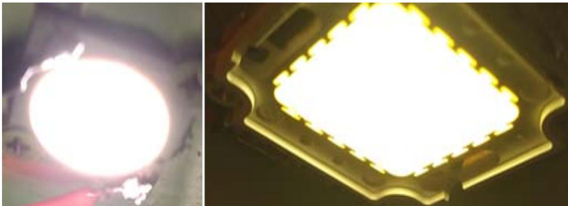
Рис. 6. Экспериментальные светильники со светодиодами 36 Вт (фото А. В. Медведева, Д. А. Попова)
